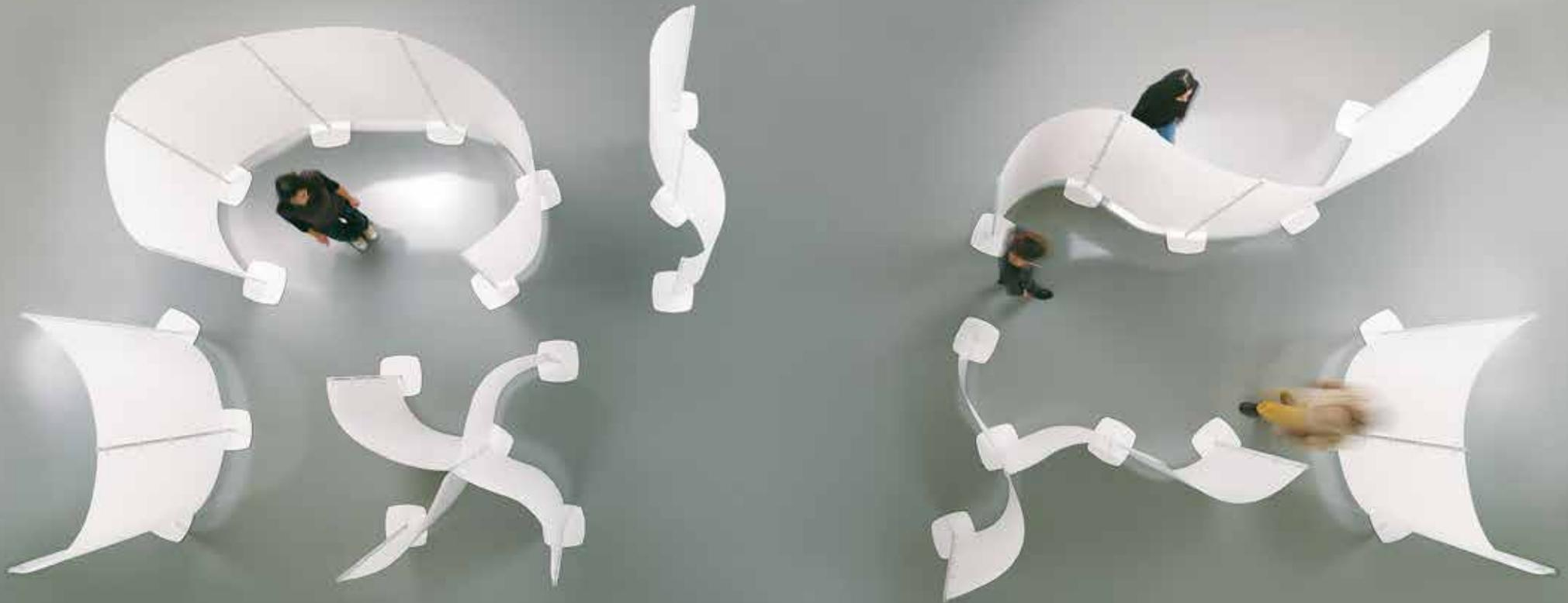
**I**\_Arianna è un sistema modulare di schermi divisori flessibili. I pannelli sono fissati ai montanti tramite attacchi fissi o particolari attacchi magnetici che consentono l'aggancio/sgancio rapido del pannello. I pannelli sono in tecnopolimero o PP mentre i montanti sono realizzati in acciaio verniciato con polveri epossidiche nei colori bianco opaco o grigio argento.
